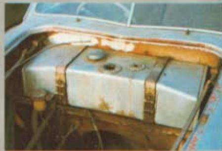
*Il serbatoio in alluminio delle berline «202», alloggiato nel vano motore, è caratterizzato da entrambi i lati obliqui per consentire l'apertura del cofano da destra o da sinistra.*
