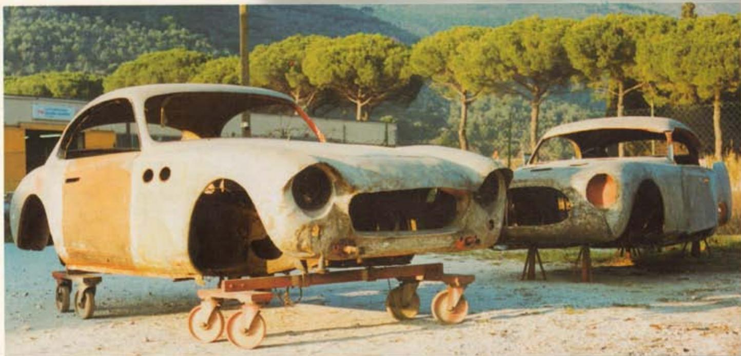
zioni rispetto a quella utilizzata a cavallo degli anni Cinquanta. Un aspetto che ci può soltanto assicurare poiché le sostituzioni dei lamierati deteriorati avverranno con laminati di composizione quasi identica a quelli originali.
