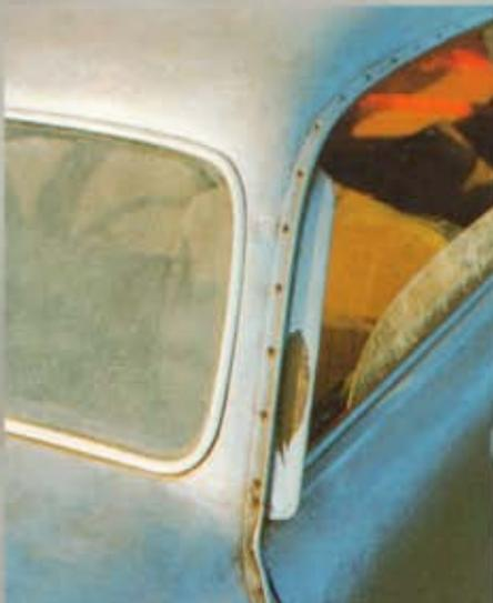
*È un particolare tra i più inconsueti il sottile gocciolatoio, fissato lungo il vano superiore delle porte, che percorre parte della fiancata della «202» contraddistinta dal telaio 008.*
