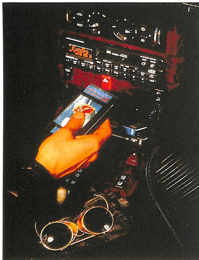
La Philips DCC 821 è la prima autoradio con riproduttore di DCC disponibile in Italia. Ha la meccanica servoassistita e il decoder RDS con 36 stazioni memorizzabili. Il display ha l'angolo di visione regolabile e doppia colorazione. Potenza di 2 x 30 o 4 x 12 Watt con montaggio in plancia estraibile. Costa due milioni 200 mila lire; il modello DCC 811 senza comandi per un CD changer è in vendita a un milione 900 mila lire circa.
