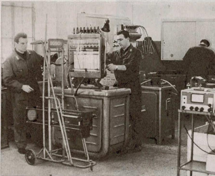
Una sala dell'Autocentro romano di P.S. con apparati per controllo fari e impianti elettrici di bordo e per taratura pompe iniezione.
