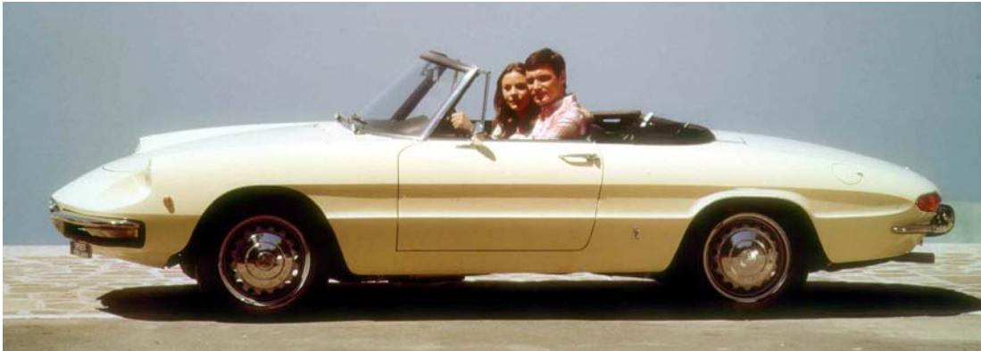
La forma, come la casa si affrettò a precisare, richiama un *osso di seppia*, ovvero la celebre conchiglia del mollusco cefalopode, in virtù del frontale e della coda arrotondati, raccordati dalle fiancate convesse, con linea di cintura piuttosto bassa. La coda, rastremata trasversalmente e longitudinalmente, segue i dettami della più classica tipologia *boat-tail*. Per la meccanica venne adottato il nuovo autotelaio della "Giulia", accorciandone il passo.
