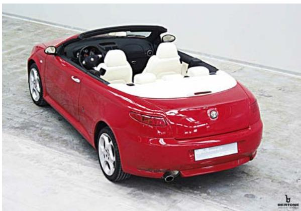
**Alfa GT Cabrio (2005)**, vista posteriore. La capote in tela ad azionamento elettrico permette di non alterare l'originario equilibrio volumetrico dell'Alfa GT. Da notare l'ampio e razionale abitacolo, in grado di accogliere quattro persone.
