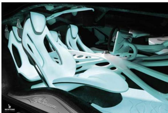
**Alfa Romeo Pandion**, dettaglio dei sedili. I sedili sono *chaise longue* ergonomiche che "galleggiano" a pochi centimetri dal pavimento. Comfort estremamente elevato ed eccellente contenimento laterale sono le principali caratteristiche di questi sedili, che adottano un telaio in fibra di carbonio e sono illuminati in blu piscina grazie a uno speciale tessuto inserito fra il telaio stesso e il rivestimento in gel.
