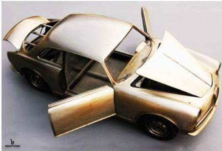
**Alfa Romeo Giulietta Sprint** – modello in scala 1/7 realizzato in un esemplare unico, in acciaio, nelle modellerie Bertone di Caprie (TO). Il pregio di questo modello è che riproduce con scrupolosa esattezza la scocca grezza della Giulietta Sprint completa di porte, cofano e baule, tutti perfettamente incernierati.
