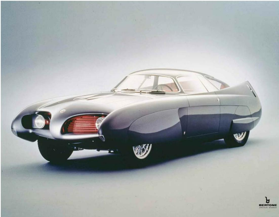
**Alfa Romeo Bat 5** (1953) – Allestita sulla base dell'Alfa Romeo 1900, della quale riprende la meccanica (motore 4 cilindri bialbero, 1.984 cc, 100 Cv a 5.500 giri/minuto), la Bat 5 viene presentata al Salone dell'Automobile di Torino del 1953 segnando una tappa storica nell'evoluzione formale della carrozzeria.
