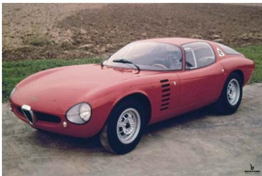
**Alfa Romeo Canguro** (1964) – Allestita sulla base del coupé Giulia TZ a telaio tubolare, la Canguro viene presentata al Salone di Torino del 1964. Il suo stile precorre il suo tempo, sfoggia un parabrezza molto inclinato e i cristalli sono incollati a filo lamiera secondo una nuova tecnica costruttiva. L'intero volume anteriore (cofano e parafranghi) è in un unico pezzo incernierato anteriormente. La coda tronca enfatizza la muscolatura del volume posteriore.
