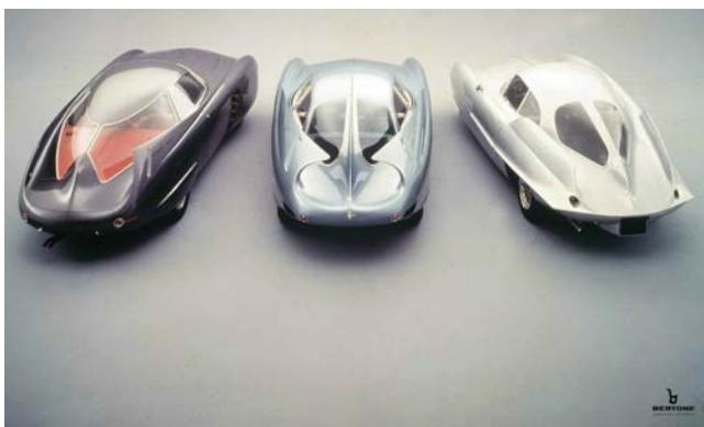
**Alfa Romeo Bat 5, 6 e 7** (1953-'55), vista posteriore – Le tre Bat condividono pianale e meccanica dell'Alfa Romeo 1900 ed esprimono una raffinata ricerca formale e aerodinamica, empiricamente condotta con gli strumenti elementari dell'epoca. L'acronimo Bat (Berlinetta aerodinamica tecnica) piacque molto agli anglosassoni (“bat” in inglese significa “pipistrello”) che vedevano nelle pinne caudali le ali ripiegate di un pipistrello.
