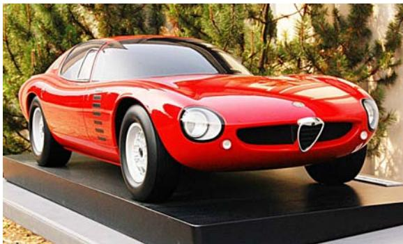
**Alfa Romeo Canguro** – modello in scala 1/4 realizzato da un blocco di “epowood”, una speciale resina impiegata in modelleria. La vettura è un “pieno” (ovvero senza interni), che permette di ammirare il perfetto equilibrio volumetrico della leggendaria Canguro e le rivoluzionarie (per allora) superfici vetrate “a filo” della carrozzeria.
