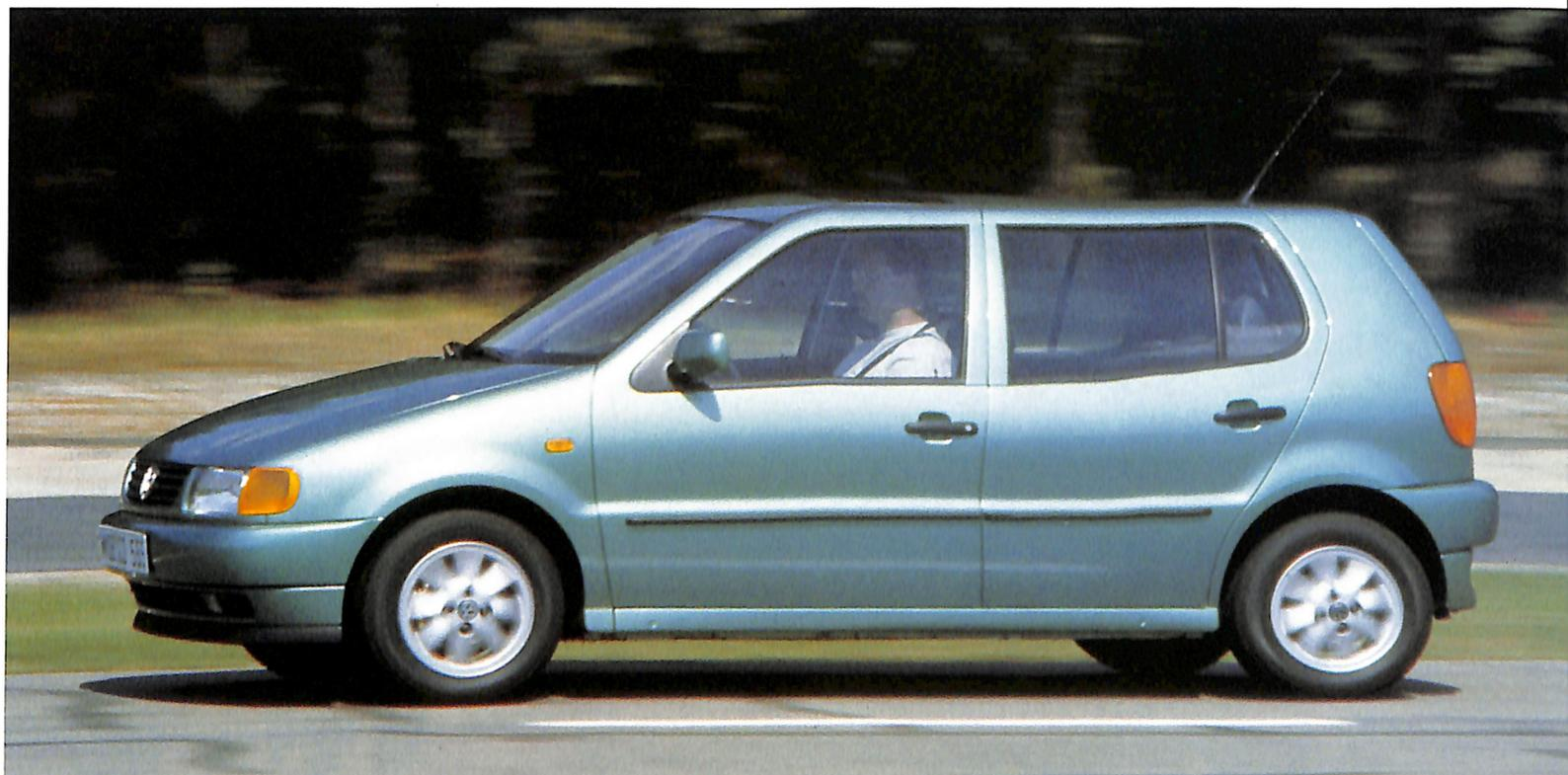
La nuova Polo è un esempio di soft design: linea ammorbidita, raccordi curati, gruppi ottici e cristalli a filo di lamiera. Via anche i gocciolatoi ai lati del padiglione. Morale, il coefficiente di forma (Cx) è sceso dallo 0,35 del vecchio modello a 0,32. Nel complesso l'aerodinamica non è peggiorata: il gran lavoro di affinamento nel tunnel del vento ha compensato l'incremento della sezione frontale dovuto all'altezza e alla larghezza maggiori.
