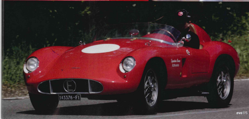
La carrozzeria della bellissima Ermini 357 1500 cc fu realizzata da Sergio Scaglietti. Il suo nuovo motore 1500 cc era costruito interamente nelle officine Ermini
