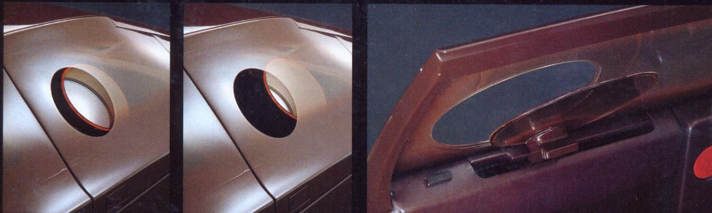
per esempio: fusi con la carrozzeria, non possono essere discendenti. Per dare aria all'abitacolo, quindi, il designer torinese escogita un sistema con aperture circolari, tipo oblò, a scorrimento orizzontale. Orizzontale è anche il movimento del tergicristallo, un'enorme spazzola che scorre lungo la base del parabrezza.
