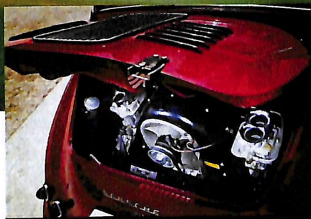
RACEARCHITECTUUR Ferry Porsche wilde de motor achterin, zodat die makkelijk toegankelijk zou zijn tijdens wedstrijden.
