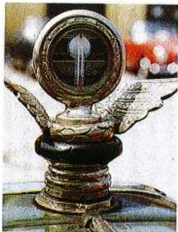
Il tappo del radiatore di questa Lambda incorpora un termometro rivolto verso il guidatore che può così avere direttamente sotto controllo la temperatura del liquido di raffreddamento del motore.
