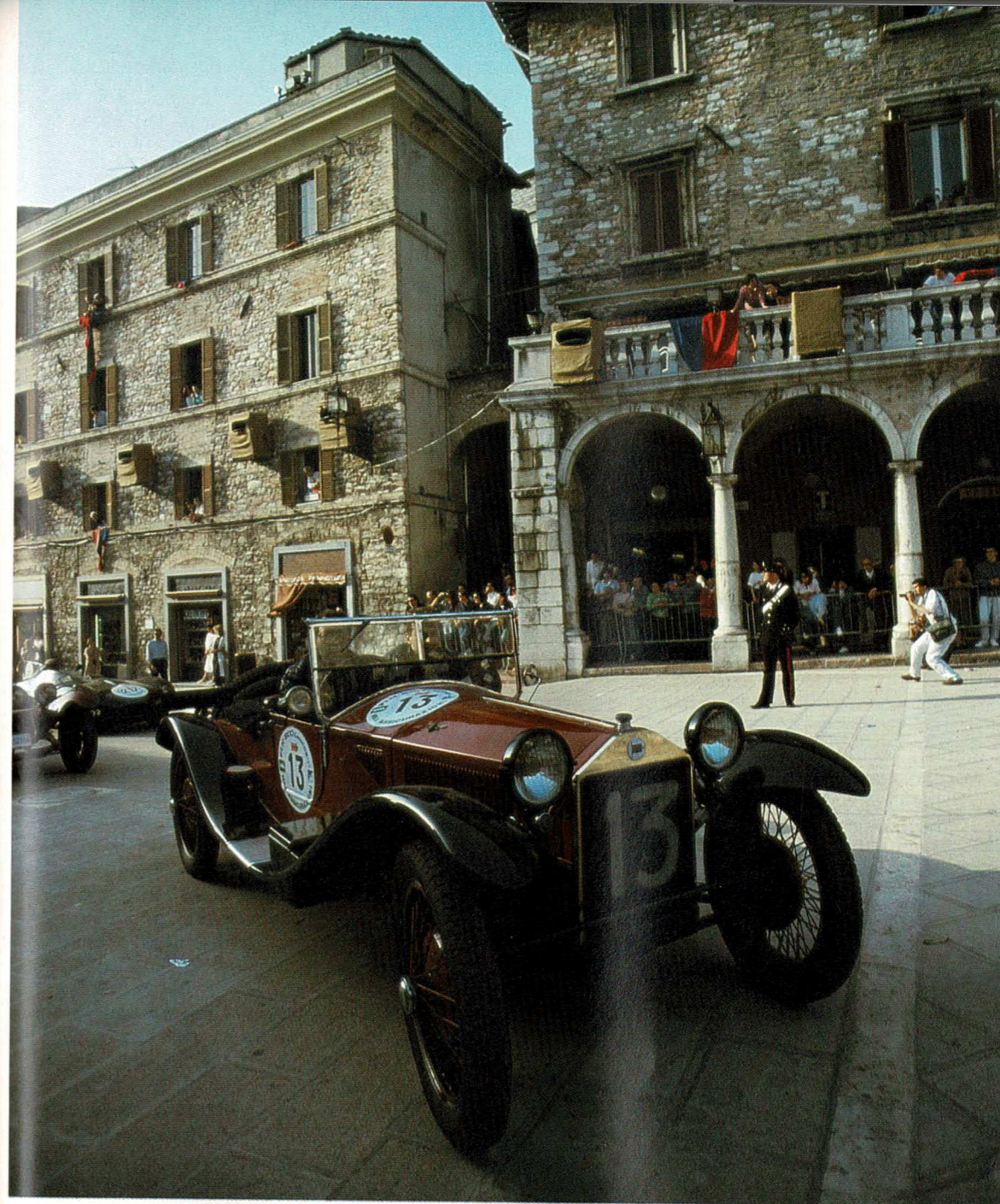
Una Lancia Lambda S del 1925, il famoso "capolavoro di Vincenzo Lancia". Questa vettura monta un motore quattro cilindri a "V" di 13°, che sviluppa una cilindrata di 2370 cm 3 e una potenza di 58 CV a 3250 giri/min. Al momento della sua prima apparizione, al Salone di Parigi del 1922, destò enorme interesse per le novità tecniche che adottava.
