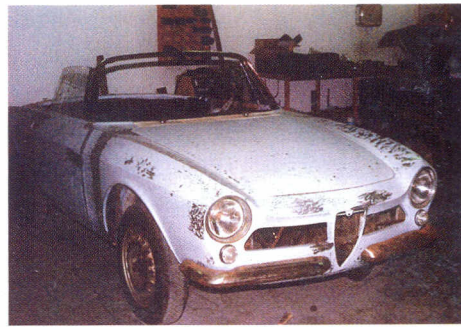
レストアを受ける前のジュリア・スプリントGTスパイダー・プロトタイプ。メッキパーツの多くにサビが蔓延する一方、ペイントが剥げ落ちたフェンダーからドアにかけてのボディパネルからは、のちの時代に溶接をやり直していたことが判明した。また、フェンダーとノーズ周りの外板がワンピースであることを含めて、ボディ各部の構成についても解明された。
