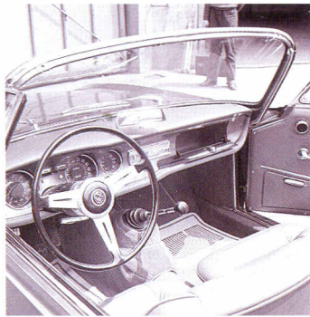
メーターやステアリング類は、ジュリエッタ・スプリント・スペチアーレからの流用が多い。ステアリングコラム下には、ジュリエッタと同系のステッキ式ハンドブレーキが見える。他方、ジュリア・スプリントGTのそれはフロアから生えるタイプ。
