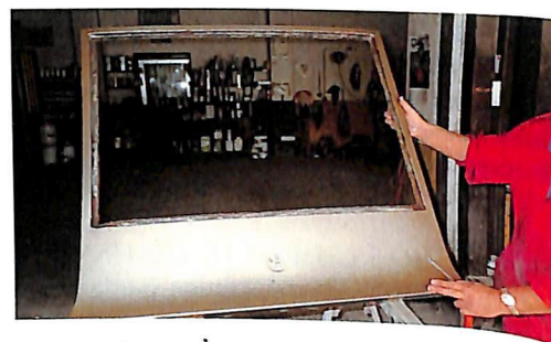
Durante lo smontaggio del portellone occorre fare attenzione al cristallo, soltanto incollato.
