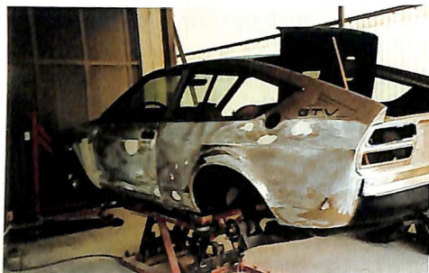
Eliminate tutte le tracce di ruggine si può procedere alla sabbatura e verniciatura.
