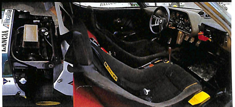
↑1975年のシーズン用に開発されながら、わずか数100kmのテストを行っただけで、リザブに回されてしまったこのマシン。エンジンは2バルブの2.40のV6。最高出力は270psとエアインテークボックスの形状はこの時代のモデルでは、さほど効率がいいとはいえないものであった。インテアでは、ダッシュボードにレザーが張られ、スバルタンな印象しかない他のモデルとの違いを感じさせる。
