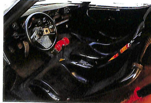
↑コックピット内部は当時のままである。4点式の サベルト、大きなフットレスト、2個の消 火器がコンペティションを感じさせてくれる。
