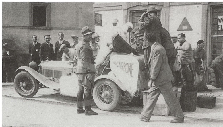
Ancora uno scatto al posto di rifornimento. Ruote di scorta, bauletto e capote erano stati eliminati per far posto al voluminoso congegno.
