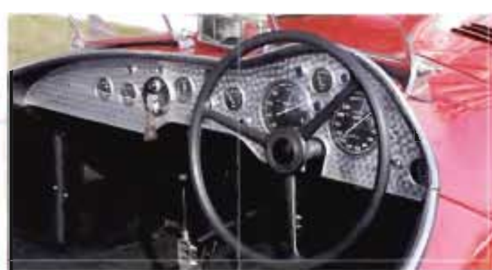
Sopra, il cruscotto in alluminio lavorato a rosette è un piccolo capolavoro di abilità artigiana nel quale ben si inseriscono gli strumenti con la loro grafica impeccabile. Si notano pure i rinvii della leva del cambio che, lasciati a vista, hanno la nuda bellezza dei meccanismi semplici ed efficienti.
