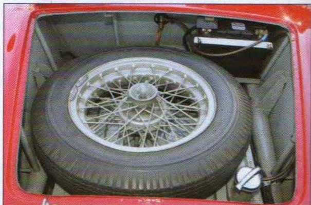
Le coffre est avant tout destiné à recevoir la roue de secours, la batterie et le réservoir d'essence que l'on devine en partie inférieure.
