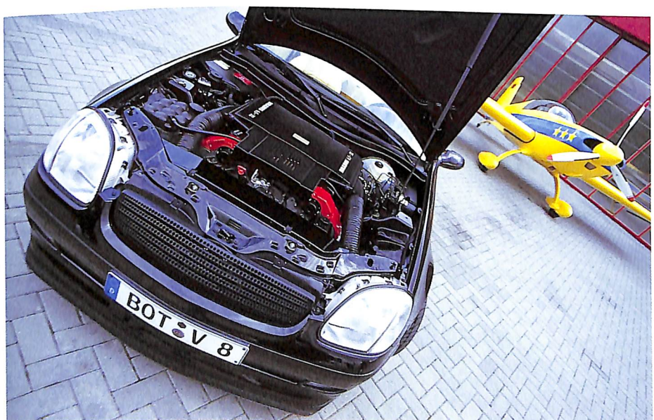
*フロント8.5J×18、リヤ9J×18サイズのモノブロックIVモジュラーアロイホイールにダンロップの最新モデルであるSP9000をセット。タイヤサイズはフロント225 40ZR18、リヤ255 35ZR18。 *コンパクトV8は意外とスムーズにボンネットへ収められた。6.5インチスケールアップして450psに。
