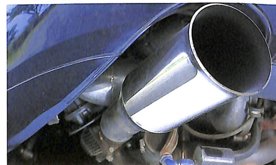
↑エキゾーストパイプもプロモデットのオリジナルに変更しチューニング。マフラーエンドは標尺ホルシェとは異なり、2本出しタイプで左側はウエイストゲート用としている。
