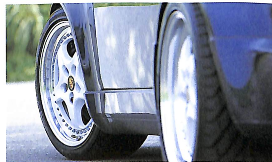
↑タイヤはフロント225/40Z R18、リヤ265/35Z R18サイズのブリヂストンS-02とスポークをホワイトにペイントしたスピードライン製3ピースのホイールを組み合わせた。
