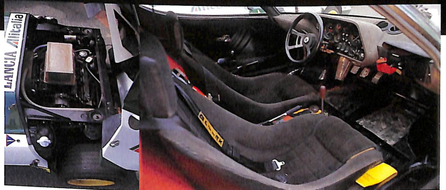
・1975年のシーズン用に開発されながら、わずか数100kmのテストを行っただけで、リザーブに回されてしまったこのマシン。エンジンは2バルブの2.4LのV6。最高出力は270psとエアインテークボックスの形状はこの時代のモデルでは、さほど効率がいいとはいえないものであった。インテリアでは、ダッシュボードにレザーが張られ、スバルタンな印象しかない他のモデルとの違いを感じさせる。
