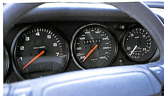
↑左からタコメーター、スピードメーター、通常時計の位置にブーストメーターを組み込んだ。時計は下に新設している。シートはドイツ仕様のオプションのホワイトレザー。
