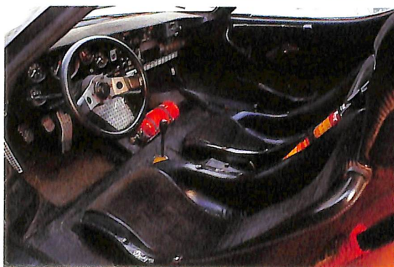
・コクピット内部は当時のままである。4点式 のサベルト、大きめのフットレスト、2個の消 火器がコンペティションを感じさせてくれる。
