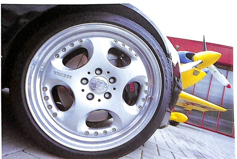
*フロント8.5J×18、リヤ9J×18サイズのモノブロックIVモジュラーアロイホイールにダンロップの最新モデルであるSP9000をセット。タイヤサイズはフロント225 40ZR18、リヤ255 35ZR18。 *コンパクトV8は意外とスムーズにボンネットへ収められた。6.5インチスケールアップして450psに。
