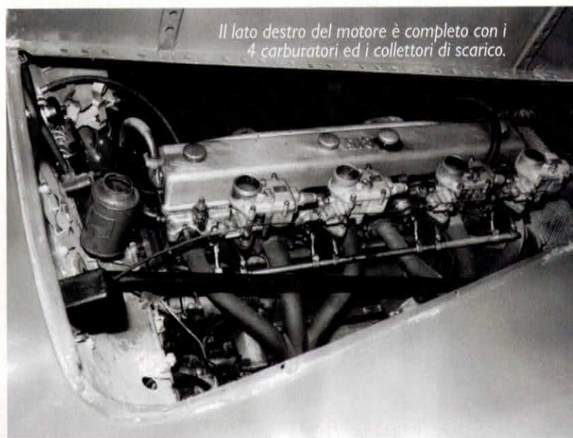
Osservando il motore restaurato si nota che al centro il monoblocco è unico mentre le due testate sono separate.
