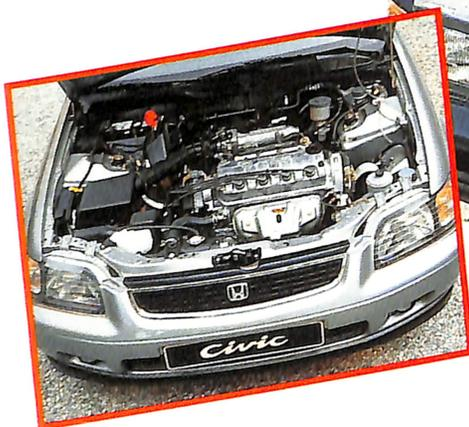
Il 1500 VTEC-E (qui sopra) e il 1600 VTEC (a fianco), entrambi con fasatura variabile a controllo elettronico. In alto: sbalzo ridotto e muso arrotondato, preziosi nelle manovre di parcheggio. Sotto: il portellone si apre a filo del paraurti.
