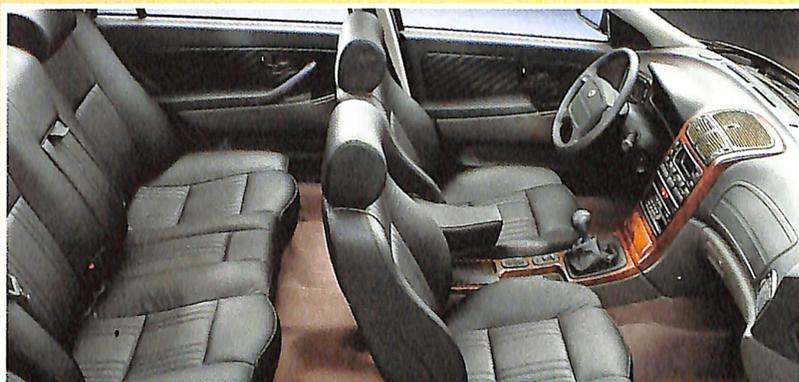
Più spazio ed eleganza per gli interni della Kappa. La vettura è lunga 469 cm per 183 di larghezza, con un passo di 270 cm. La capacità del bagagliaio è di 565 dm<sup>3</sup>. I sedili anteriori hanno un supporto lombare automodellante. I rivestimenti sono in velluto, Alcantara o, a richiesta, in pelle.
