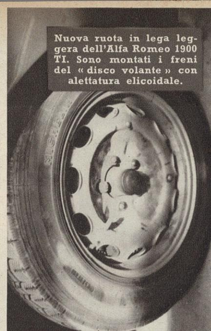
Nuova ruota in lega leggera dell'Alfa Romeo 1900 TI. Sono montati i freni del «disco volante» con alettatura elicoidale.
