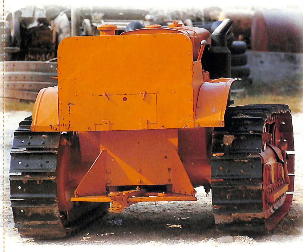
L'«Ursus» ha un motore monocilindrico due tempi a testa calda con cilindrata di 11.200 cm 3 . La potenza è di 55 CV a 720 giri e il peso complessivo del trattore di 52 quintali.
