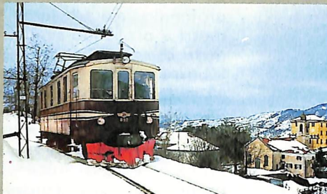
Nella cartolina inviata da Guido Bevegni di Genova appare la locomotiva Carminati & Toselli del 1929 munita di spartineve.
