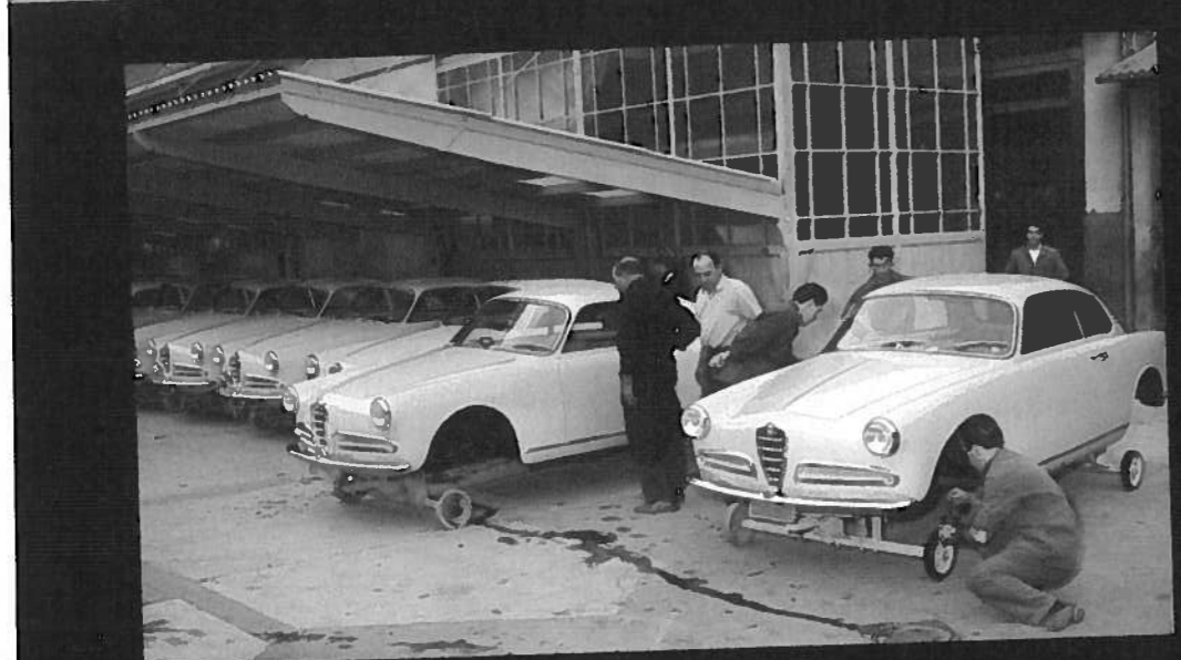
コルソ・ベスキエラ工場で作成したジュリ エッタ・スプリントのモノコックボディ。この時 代には、サスペンションやタイヤなどの組み 付けはアルファ・ロメオのボルテッロ工場 で行われていたため、小さな車輪の付いたキャ リアに載せて移動させることになっていた。
