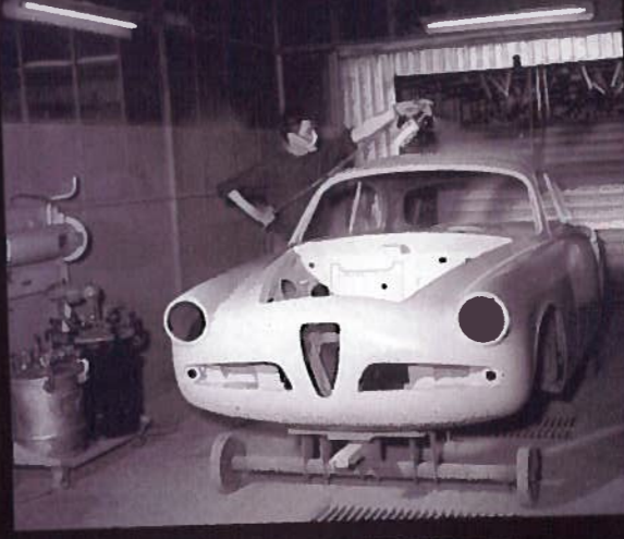
1955年秋半頃になると、ベスキエラ工場が拡大されるとともに、塗装ブースも完成するなど、ジュリエッタの量産体制は格段の進歩を遂げたことになる。もちろんベルトーネは手抜きだが、そのフィニッシュは当時の量産車としてはかなり上質なものであった。また1956年以降には、ベルトーネが独自にフォグランプやホイールリング、フェイスピンナー付ホイールキャップなどを特別装備したドレスアップ版も限定製作されることになった。
