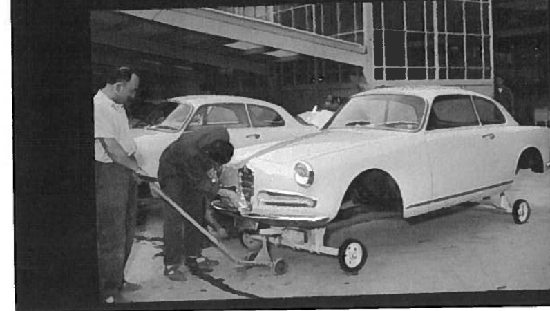
コルソ・ベスキエラ工場で作成したジュリ エッタ・スプリントのモノコックボディ。この時 代には、サスペンションやタイヤなどの組み 付けはアルファ・ロメオのボルテッロ工場 で行われていたため、小さな車輪の付いたキャ リアに載せて移動させることになっていた。
