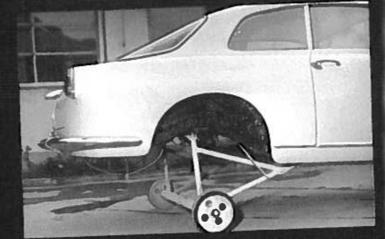
コルソ・ベスキエラ工場で作成したジュリ エッタ・スプリントのモノコックボディ。この時 代には、サスペンションやタイヤなどの組み 付けはアルファ・ロメオのボルテッロ工場 で行われていたため、小さな車輪の付いたキャ リアに載せて移動させることになっていた。
