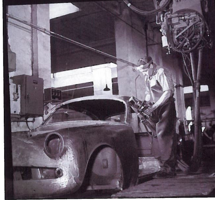
ベルトーネはトリノ市内コロッセスキエラ通りの工業団地に、第一次大戦前の創業当時からの工場を構えていた。ジュリエッタ・スプリントのボディも、デビュー当初からこの工房で製作されたが、54年の以降でベルトーネはアーノルドMG TDの生産も並行しており、得意の鍛金技術を生かしたペダント製モノコックの製作で手一杯だった。
