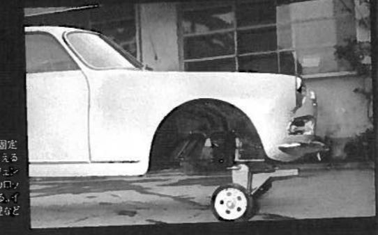
フロ・ボトリアに一台ずつのキャリアを固定 され、ミラノ・ボルテッロへの移動に備える ジュリエッタ・スプリントのモノコック。フエン ター内のつくりなどにも、当時の老練カロッ ツェリアの高い鑄造技術が感じられる。イ ンナーフェンダーのアンダーコート処理など リストア時の参考にもなる。
