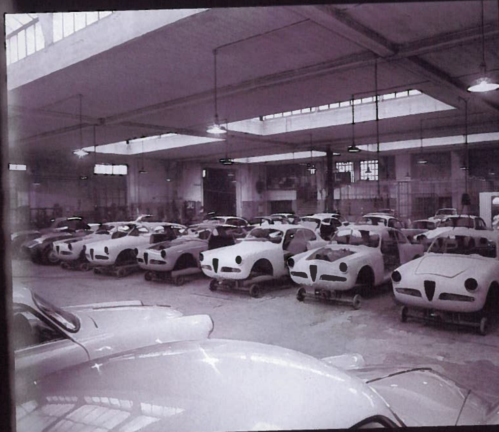
工場内に並べられたモノコック完成品。左端には同時代にベルトーネが生産を担っていたアーノルド・フリスタの姿も見受けられる。これも歴史を語る貴重なショットだろう。
