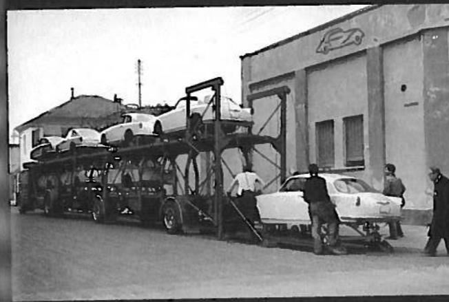
車載トラックで運ばれるモノコック。ベ ルトネのあるトリノからアルファ・ロメ オの生産拠点であるミラノへの距離 は120km以上も離れており、スプリ ントのヒット拡大によって、生産効率 の悪さが指摘されていた。
