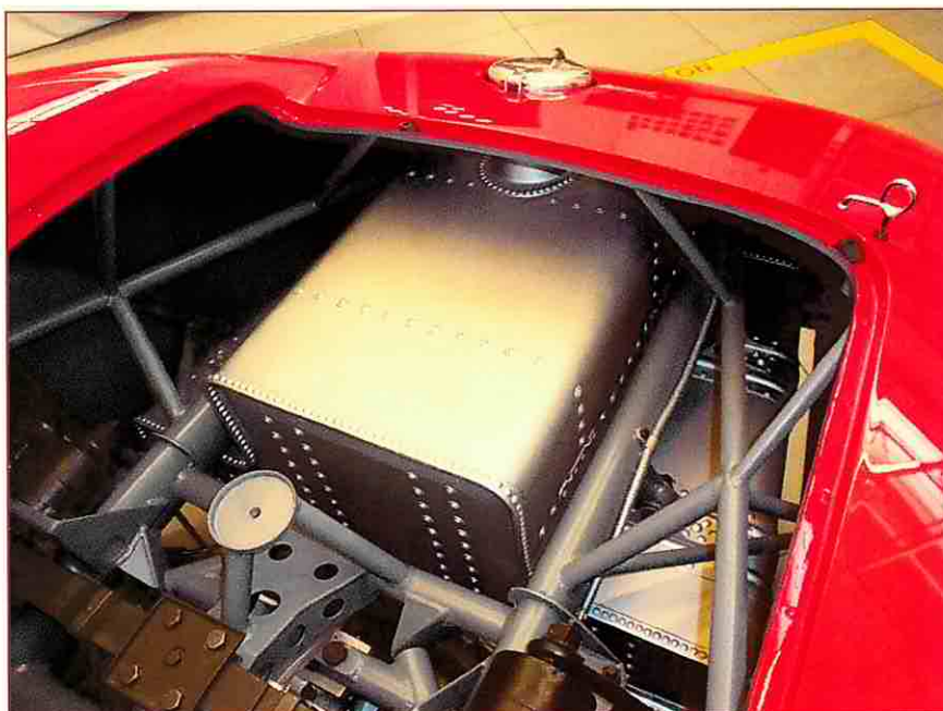
Serbatoio carburante (se accessibile)
