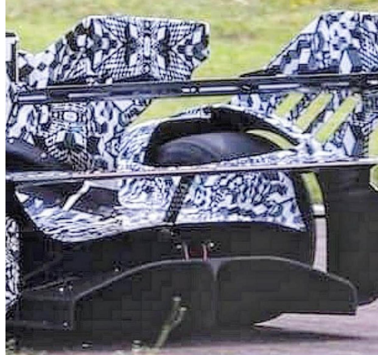
Infatti, a differenza degli altri prototipi che presentano gli scarichi sulle fiancate, in Ferrari hanno optato per una configurazione alta dei terminali. Ciò significa che il propulsore, con ogni probabilità un V6 sovrallimentato a 120°, avrà i turbocompressori alloggiati all'interno delle bancale. La LMH, come da regolamento, sarà inoltre dotata di un motore elettrico che erogherà 200 kW esclusivamente sull'asse anteriore.
