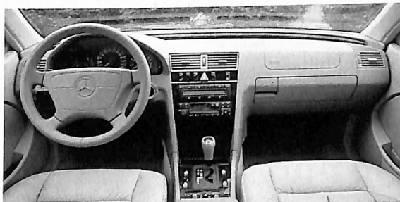
↑ Cクラス全車種にサイドエアバッグを標準化。クルーズコントロールには可変スピードリミッターがついた (C240/C280)。パワーウィンドウはセーフティリミッターを採用。↑ 2.4L V6ユニットは2.3L直4に比べ20psパワーアップ。C280は直6からV6ユニットへと変更された。↑ ホイールは従来と同じデザイン。タイヤサイズは195/65R15と同一。
