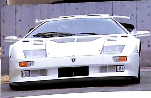
←フロントフードのエアアウトレットの形や追加アウトレットなど、3台とも微妙に違う。ルーフ後端のエアバルジにも注目したい。イオタがレース用に開発されたのがよくわかる。
