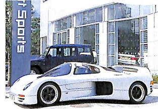
'92 VERN SCHUPPAN 962CR シルバー・空冷水平対向6気筒DOHC24バルブ+ ツインターボ・3,400cc・600ps/7000rpm・ 66.3kg/5400rpm・100タンク
