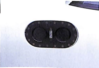
←燃料給油口はもちろんレース用だ。安全タンクはエンジンのサイド、フエンダーの前に収められている。
