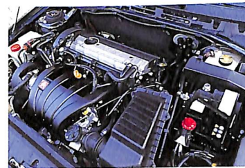
1.8・16Vのエンジンは1761ccの直4・16バルブ。最高出力112ps/5500rpm。最大トルクは16.1kgm/4250rpmで、2500~5000rpmでその90%以上を発揮する柔軟性を持つ。
