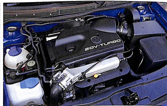
↑ニューゴルフには、合計8タイプのエンジンをラインナップした。ベーシックなのは1.4ℓの直4オールアルミエンジンで最高出力は75ps。その他1.6ℓ(100ps)、1.8ℓ(125ps)、1.8ℓターボ(150ps)、2.3ℓV5(150ps)のほか、1.9ℓディーゼル(68ps)、1.9ℓ直噴ターボディーゼル(90ps)を用意。多彩なバリエーションが魅力でもある。
