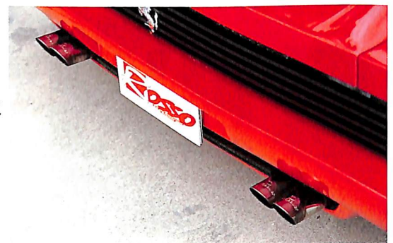
→リヤエンドを締めるステンレスのエキゾーストシステムはオールステンレス製。サウンドにもアイディングのこだわりが感じ取れる部分である。
