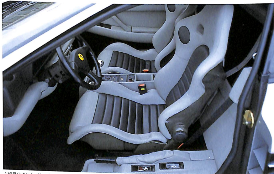
*軽量化されたバケットシートはアイディングのオリジナルアイテム。背面にカーボンのシェルを採用し、耐久性や剛性感も飛躍的にアップさせた。
