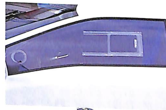
←燃料給油口はもちろんレース用だ。安全タンクはエンジンのサイド、フエンダーの前に収められている。
