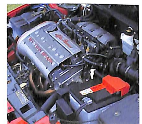
* 145クアドリフォリオの5ドア版がこのTi。2.0直4 DOHCツインスパーク16バルブユニットを搭載する。最高出力は150psを誇る。
