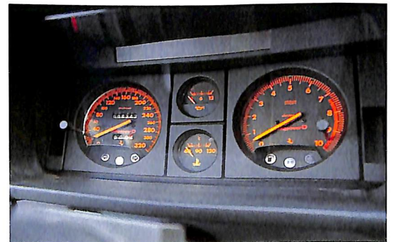
*フルチューンのF512TRにとって、1万回転、320km/hまで刻み込まれたメータースケールは伊達ではない。実用上、必要不可欠なパーツなのだ。
