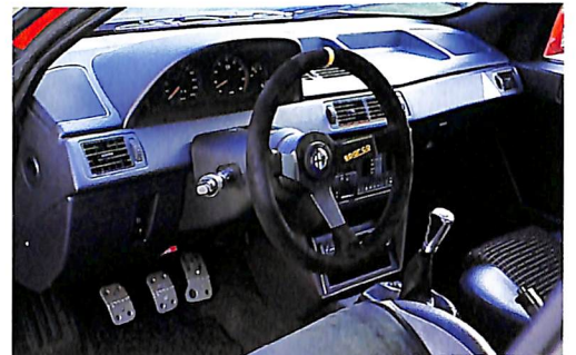
↑ツェンダー製アルミシフトノブ以外はステアリングホイール、ペダルキット、シートともスバルコ製だ。ドライビング時に操作するポイントだけ、機能性の高いパーツへ変更。
