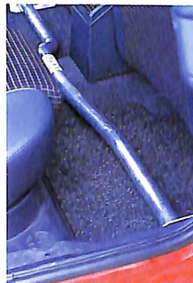
↑GAPの最新オリジナルアイテムがセンタープレース。ジムカーナなどハードな走行時に威力を発揮。センター部の剛性をアップ。
