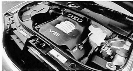
↑低速時に長く、4000rpmを超えると短いパイプに切り替えるデュアルバースインテークマニホールドによりどの速度域でも高トルクを發揮。
