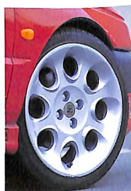
* 155ベースのザガートT1-Z用の17インチサイズをチョイスする。タイヤは205/40ZR17というレアなサイズのピレリP7000。
