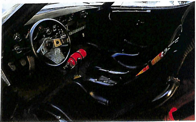
↑ムナリーの仕事場となったストラトスのコックピット。皮革性のバケットシートが時代を感じさせる。4点式のシートベルトが窮屈感を盛り上げる。ドア内側の巨大なポケットにはヘルメットがそのまま収納できた。
