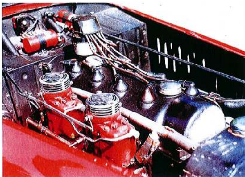
L'«Astura» in versione «Mille Miglia» monta il motore a otto cilindri a V della berlina di serie, ma con cilindrata maggiorata. La distribuzione è ad asse a camme centrale.
