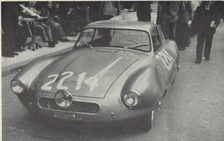
Ispirato al « Disco Volante » questo coupé dal peso di soli Kg. 90 realizzato dalla Colli per il telaio Dyna Panhard.
