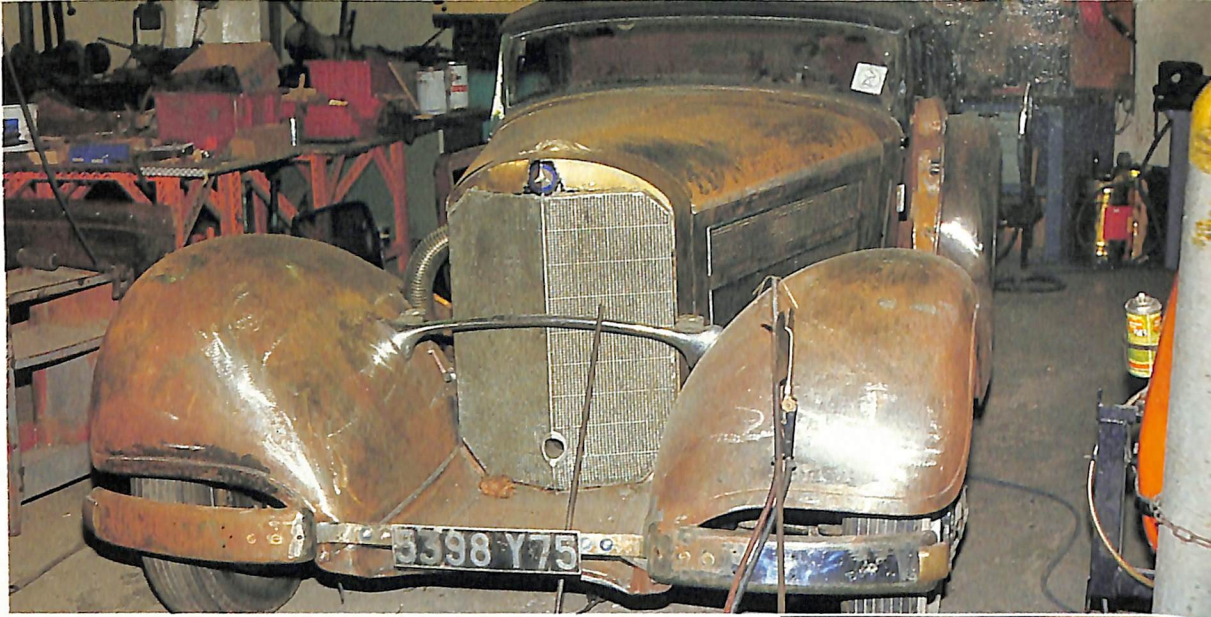
Avant la peinture et le rechromage, tous les éléments et accessoires de carrosserie sont présentés, puis redémontés. Ici une Mercedes 540.
