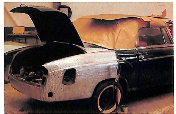
On a longtemps attendu une aile arrière neuve pour ce cabriolet Mercedes : puis on s'est résolu à réparer : « tout est possible en carrosserie ».
