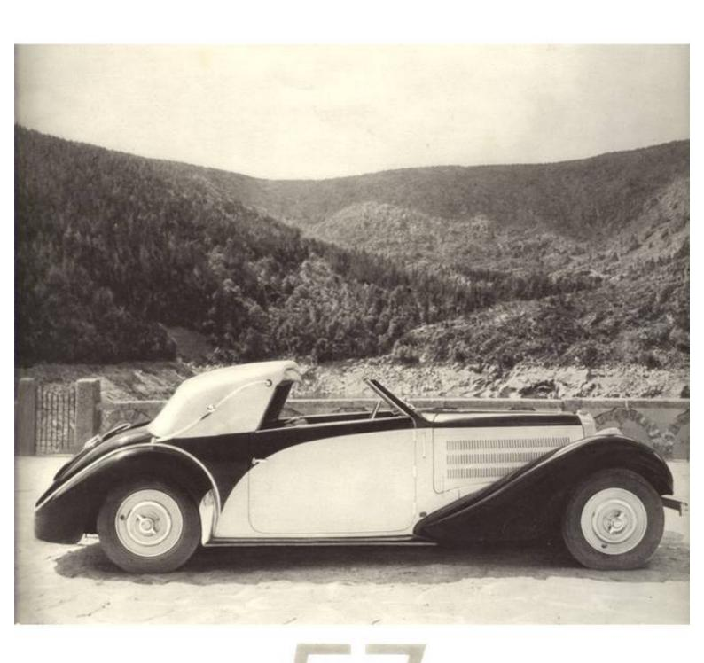
Châssis "Type 57" avec carrosserie Cabriolet décapotable "STELVIO" - 4 places - 2 portes
