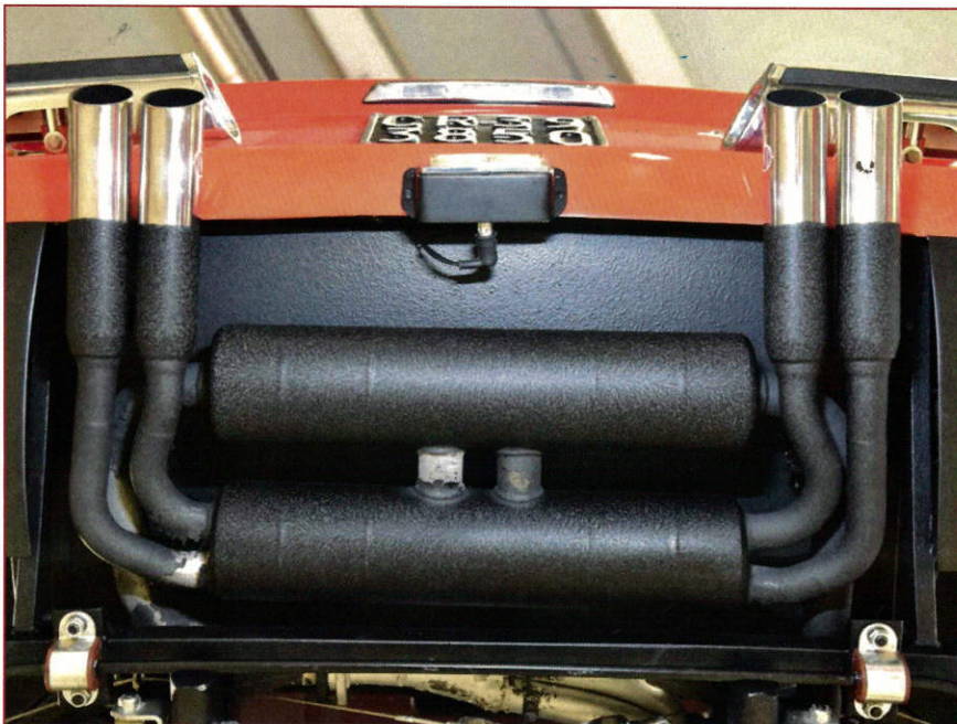
Impianto di scarico Exhaust silencers and outlets
